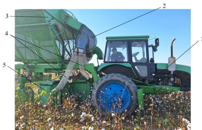
Рис. 4. Полунавесная экспериментальная машина модернизированной ПТС в процессе сбора хлопка: 1-трактор, 2-вентилятор с усовершенствованной боковой стенкой и воздухосборника, 3-бункер, 4-гофрированные транспортирующие трубопроводы, 5-уборочный аппарат
